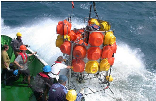
**Probenentnahme vom Forschungsschiff aus mit sog. „Landern“.**
